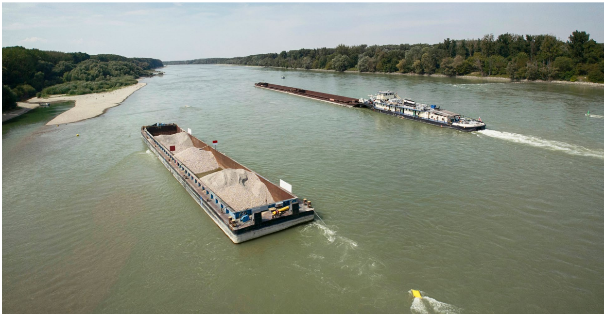
2024 im Pilotversuch an der Furt „Rote Werd“ getestet: eine mit Kies beladene Transportschute als „flexible Infrastruktur“.
