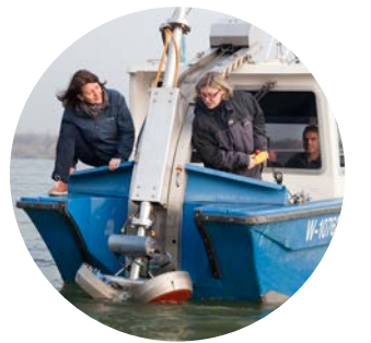
Mit dem Fächerecholot wird das Flussbett der Donau regelmäßig vermessen.
