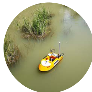
Die schwimmende elektrische Drohne dient der Tiefen- messung in Bereichen, die für bemannte Messboote zu seicht sind.
