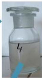
Sklená nádobka obsahujúca PET fľašu po miešaní vo vode po dobu 1 mesiaca.
