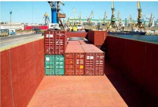
Barge mit verstärktem Boden. © First DDSG
