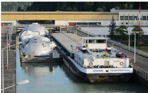
Schwertransport Reaktorteile, Schleuse Aschach.
