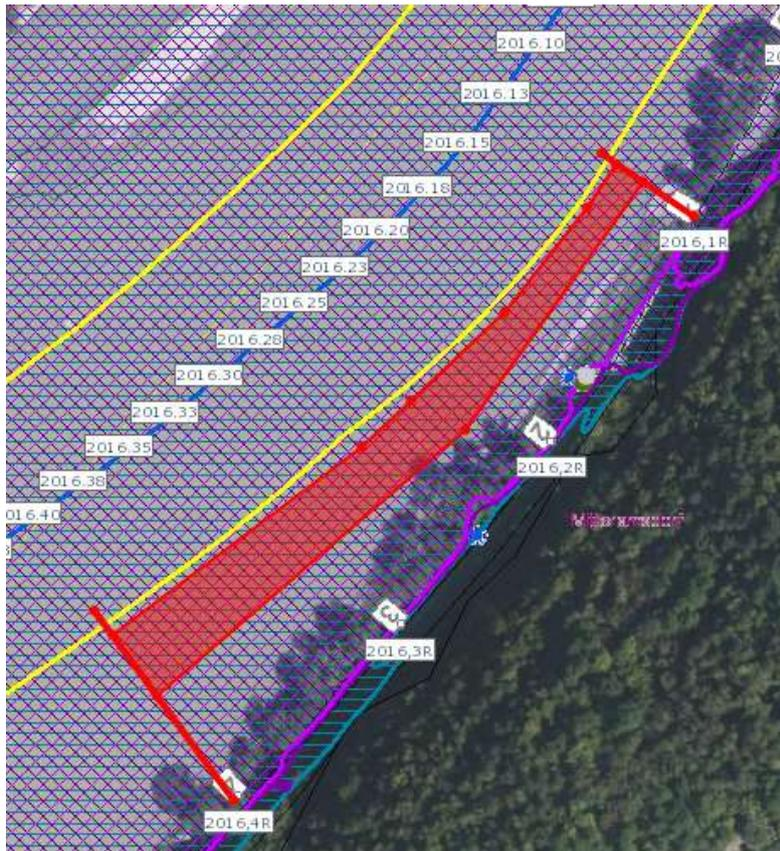
Abbildung 11: Hochwasserabflussbereich HQ30 / HQ100 / HQ 300 - Mitterarnsdorf
