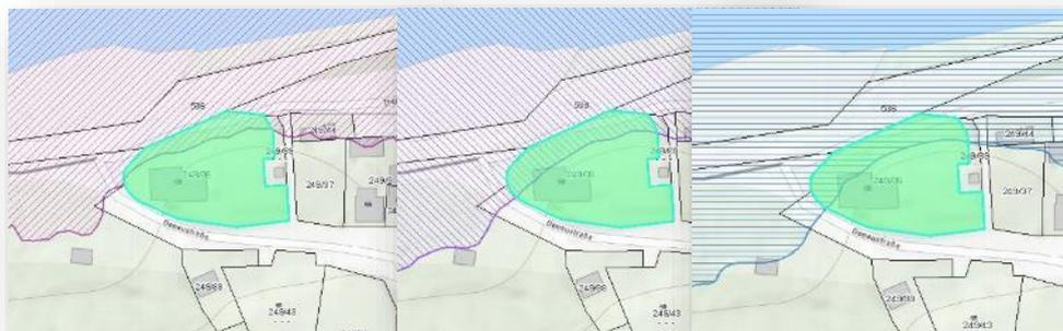
Abb. 8: Hochwasser-Abflussbereich, von links nach rechts HQ30, HQ100, HQ300
