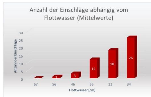
Abbildung 5: Anzahl der Einschläge in Abhängigkeit vom Flottwasser (Mittelwert)
