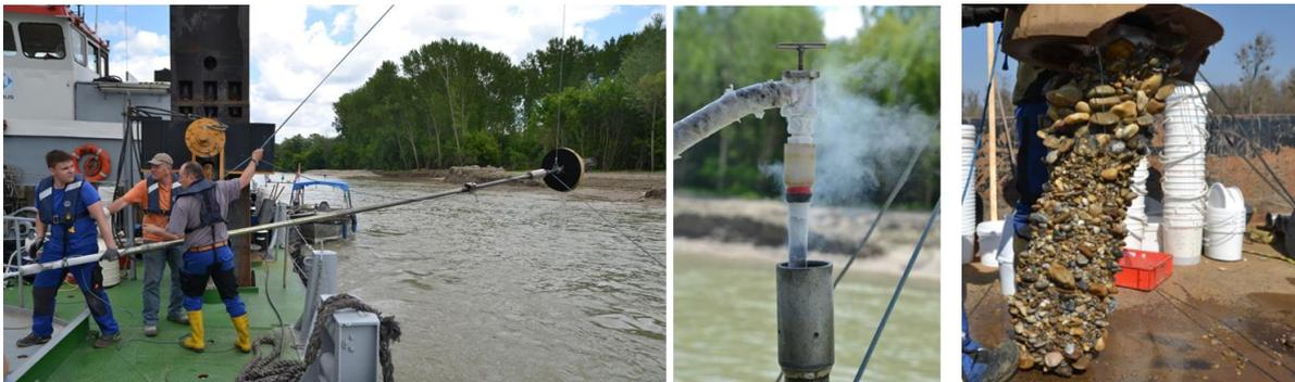
Abbildung 4: Linkes Bild – einbringen des Freeze Core Gestänges; mittleres Bild: gefrieren der Donausohle mit Flüssigstickstoff; rechtes Bild: Freeze Core Probe mit GSV Schicht
