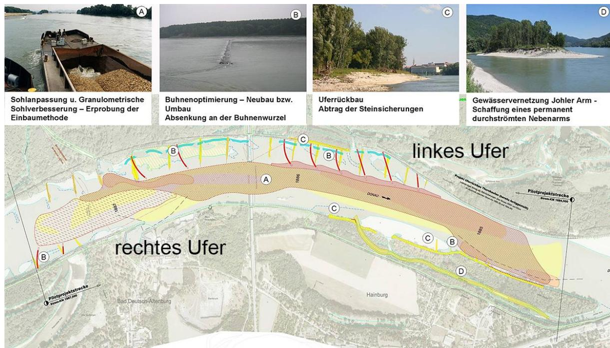
Abbildung 3: Maßnahmen des Pilotprojekts Bad Deutsch-Altenburg (Strom km 1887,5 – 1884,5)
