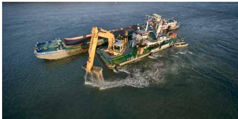
Der im Rahmen der Instandhaltung der Schifffahrtsrinne gebaggerte Kies wird dem Fluss stromauf wieder zugegeben.
