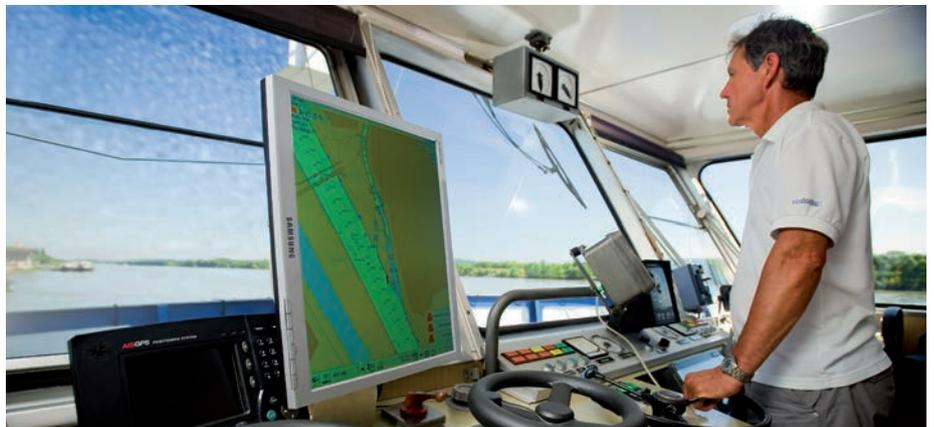
Darstellung des aktuellen Verkehrsgeschehens auf einer elektronischen Binnenschifffahrtkarte.
